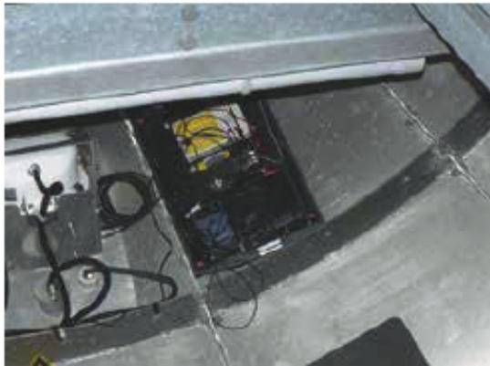
*Fern-Mikrofon am Boden der Gondel (oben), verbunden mit automatischem Fledermaus-Detektor in der Gondel (unten) © L. Bach*
