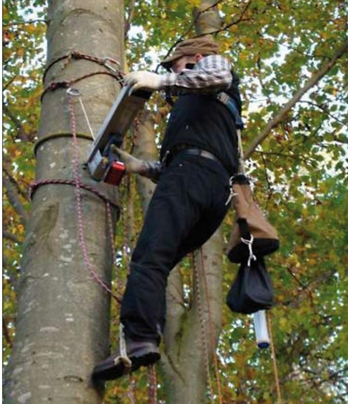
Abb. 3: LUIS SIKORA bohrt mit dem Resistographen (IML) in eine Initialhöhle, um festzustellen, ob eine Fäule dahinter sitzt.
