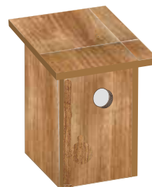
Abb. 6: Vertikal angebrachter Holznistkasten. Rückwand (37 x 26 cm), Seitenwände abgeschrägt (37-33 x 26 cm), Vorderwand (26 x 33 cm), Loch (6 cm), Boden (28 x 28 cm), Dach (34 x 34 cm). Diese Masse sind Richtwerte und können problemlos je nach Situation angepasst werden.
